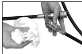
2 - Positionnez en vis-à-vis le raccord mâle du flexible d'entrée du scie circulaire et le raccord femelle de la rallonge flexible.
