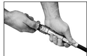
4 - Répétez les actions 2 et 3 pour les raccords femelle du flexible de sortie du scie circulaire et le raccord mâle de la rallonge flexible.
