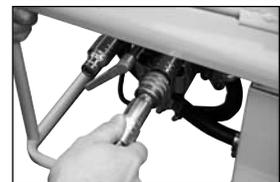
7 - Essuyez l'huile hydraulique perdu en branchant les tuyaux (flexibles).
