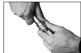
5 - Essuyez et nettoyez les raccords d'entrée et de sortie sur la centrale hydraulique **MARUZEN UH070** à l'aide d'un chiffon sec.
