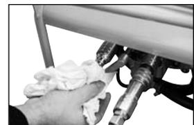
6 - Branchez les deux raccords mâle et femelle de la rallonge flexible aux raccords de la source sur la centrale.
